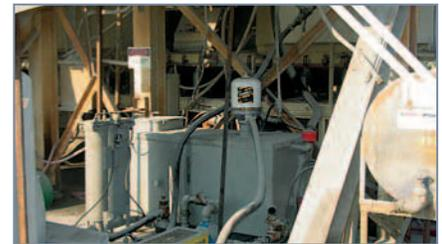
Sur un concasseur à cône, une centrifugeuse Spinner II peut convertir le débit d'huile en un piège puissant pour éliminer les débris causant l'usure. Pour vous et vos clients miniers / agrégats, cela représente une formidable opportunité. Un moyen fiable et efficace de nettoyer l'huile dans les systèmes de lubrification des concasseurs sans le gaspillage et les dépenses d'éléments jetables. L'investissement se paye en quelques mois.
